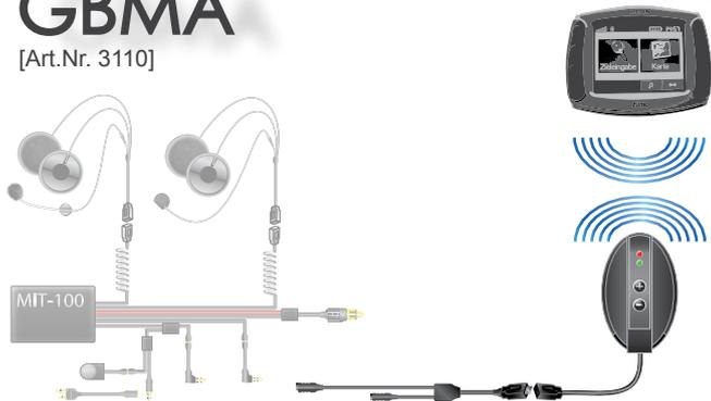
Bluetooth Adapter. Ermöglicht die kabellose Einbindung von Garmin® Navigationsgeräten in die MIT/MIP-Serie.
