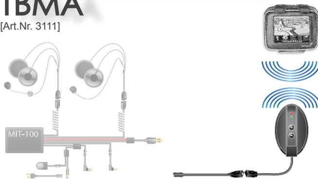
Bluetooth Adapter. Ermöglicht die kabellose Einbindung von TomTom® Navigationsgeräten in die MIT/MIP-Serie.
